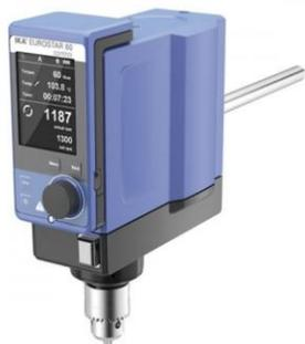
Верхнеприводные мешалки серии EUROSTAR – это оптимальное решение для перемешивания и смешивания веществ и материалов, как с низкой, так и с высокой вязкостью. Мешалки моделей EUROSTAR способны перемешивать до 100 литров материала с различной вязкостью до 150 000 мПас.
