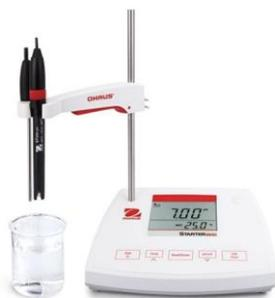
Производитель высокоточных и долговечных весоизмерительных приборов, компания OHAUS, представляет вам линейку настольных приборов для измерений электрохимических параметров. Эти приборы предназначены для измерения солености, общего содержания (TDS) и редокспотенциала (ОВП), а так же pH и удельной электропроводности.
