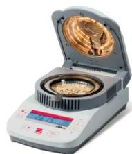
Различные отрасли промышленности (фармацевтическая, химическая, пищевая и другие) в своих исследованиях используют гравиметрический метод определения влагосодержания, характер которого, основанный на измерении массы определяемого компонента, выделенном в виде веществ определённого состава, нашел свое применение при производстве анализаторов влажности МВ.
