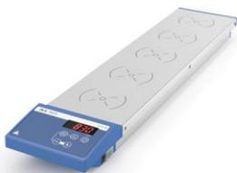
Нагревательный элемент прибора равномерно распределяет температуру по всей поверхности нагревательной платформы. Прибор имеет реверсный режим работы для оптимального перемешивания. Использование неизнашиваемых электромагнитных модулей обеспечивает бесшумное и равномерное перемешивание.
