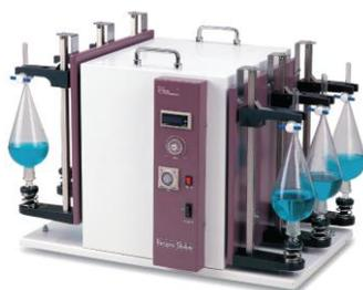
Шейкер Jeio Tech RS-1 в стандартной комплектации может одновременно взбалтывать в одинаковых условиях до 6 делительных воронок. При установке дополнительных держателей с каждой стороны можно закрепить до 5 воронок (всего 10).
