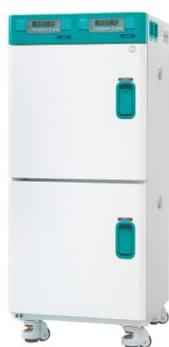
В данном разделе представлены двух и четырех-камерные сушильные шкафы OF-02G с принудительной конвекцией воздуха и микропроцессорным контроллером с функцией автонастройки. Эти шкафы рекомендуются для высушивания, спекания, предварительного нагревания, а также для проведения тестов на старение материалов и т.п.
