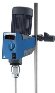
Верхнеприводные механические мешалки серии RW предназначены для перемешивания и смешивания веществ и материалов с различной вязкостью. Максимальный объем перемешивания для серии RW составляет 200 литров. Мешалки моделей RW подходят не только для лабораторного использования, но и для пилотных и опытных установок.
