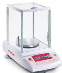
Шесть моделей весов позволяют производить измерения с наибольшим пределом взвешивания от 65 до 210 грамм (дискретность 0,1 мг).
