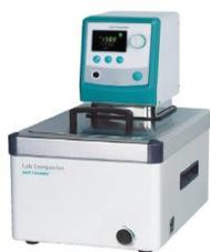
Лабораторные циркуляционные бани серии CW-G фирмы Jeio Tech имеют мощный насос, который обеспечивает внутреннюю и внешнюю циркуляцию. Возможность внешней циркуляции позволяет проводить термостатирование других приборов. Давление насоса регулируется 5 ступенями. Также все модели лабораторных циркуляционных термостатов имеют встроенный контур водяного охлаждения.
