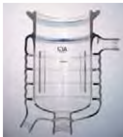
Рис.2 Вид в разрезе реактора с кольцевыми перегородками
