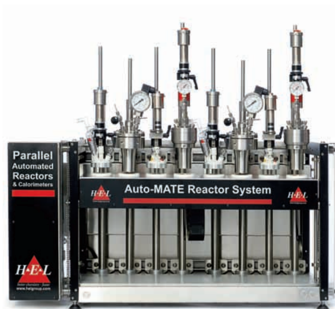
8 различных реакторов в одной системе AM8 со съемным нагревателем, позволяющим сохранять разницу в 100^{\circ}\text{C} между отдельными реакторами
