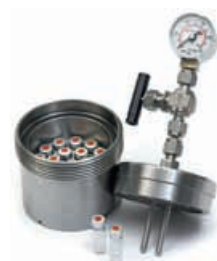
Реактор CAT 18 с 18×1 мл пробирками для работы под давлением
