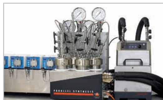
4 реактора высокого давления по 300 мл, полная автоматизация
