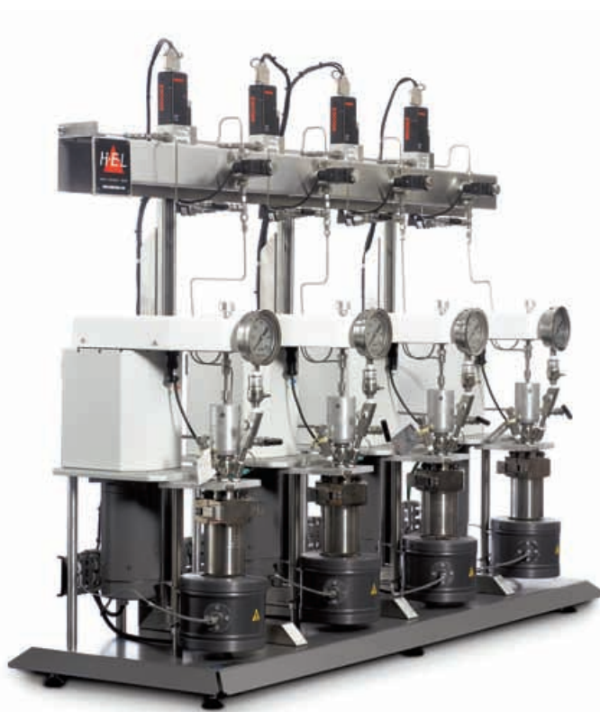
Параллельные реакторы с независимым контролем для гетерогенного катализа
