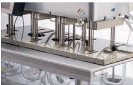
Модель PTWS 820D оснащена ручным устройством одновременной подачи таблеток в сосуды
