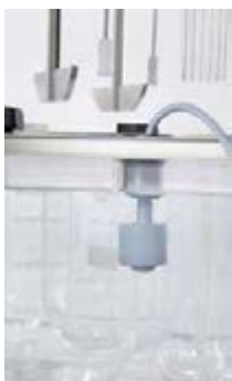
Датчик уровня воды сигнализирует о низком уровне воды в бане
