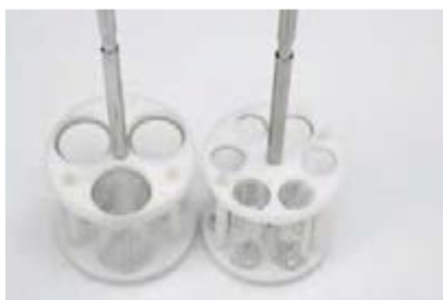
Качающиеся корзинки тип В и тип А
