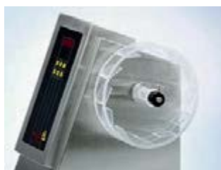
Абразивный барабан с 12 лопастями
