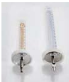
Градированные цилиндры на 100 и 250 мл к прибору PT-TD 200
