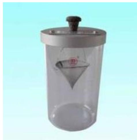
Аппарат для испытаний на отделение масла НК-392 соответствует стандарту GB/T392. Прибор применяется для определения тенденции консистентных смазок к выделению масла при хранении, как в полных, так и частично заполненных ёмкостях.
