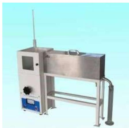
Модели: НК-6536 одна трубка, охлаждение с помощью водяной бани; НК-6536А одна трубка, охлаждение с помощью компрессора
