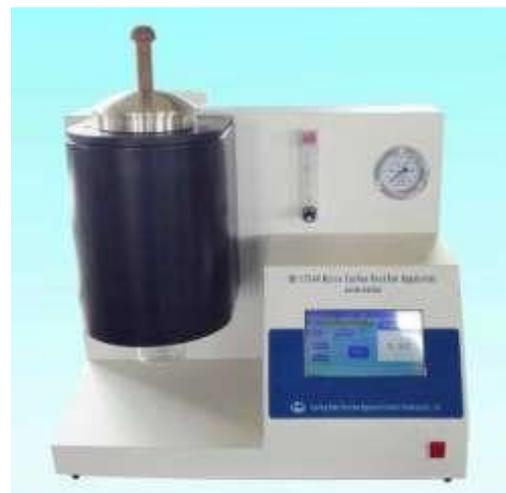
Тестер для определения осадка в нефтепродуктах НК-511 соответствует ГОСТ Р ИСО 10307-1-2009, ASTM D4807 (стандартный метод определения осадка в сырой нефти методом мембранной фильтрации).
