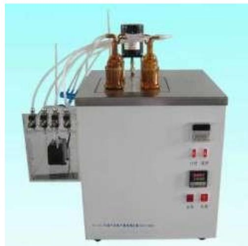
Приборы для определения концентрации фактически растворённых смол НК-8019А, В, С, D, Е соответствуют ГОСТ 1567-97, ISO 6246-95, ASTM D381 (стандартный метод определения концентрации фактически растворённых смол в топливах испарением в струе пара). Приборы данной серии применяются для определения содержания смол в авиационных и моторных топливах, а также в других летучих продуктах нефтепереработки, в т.ч. содержащих спирт, другие оксигенаты и добавки для удаления отложений.
