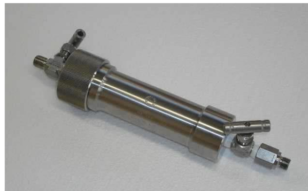
Бомба из нержавеющей стали с клапанами
